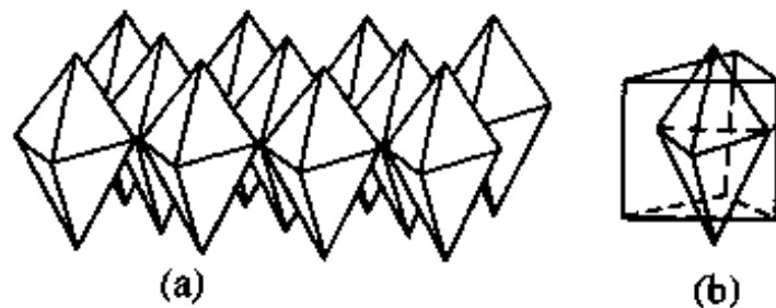
图 11-5 \text{LaF}_3 晶体结构
