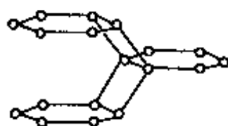
图 9-45 CAN 沿 [010] 方向的四六元环堆积图
