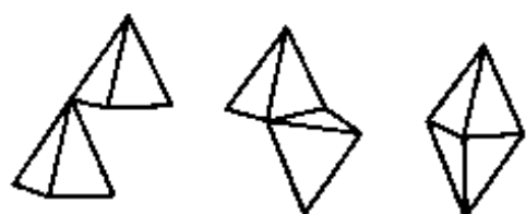
图 8-16 两个四面体的连接情况
