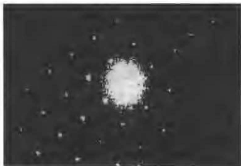
图 6-16 \text{GdBa}_2\text{Cu}_3\text{Cl}_{2-x}\text{O}_y ( x < 0.4 ) 的电子衍射图
