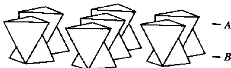
图 9-1 \text{Al}_2\text{Cl}_6 二聚分子结构
