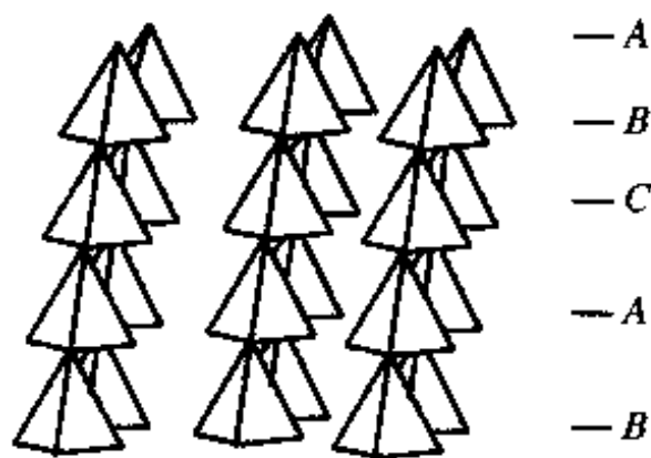
图 9-8 \text{SO}_3 分子的结构
