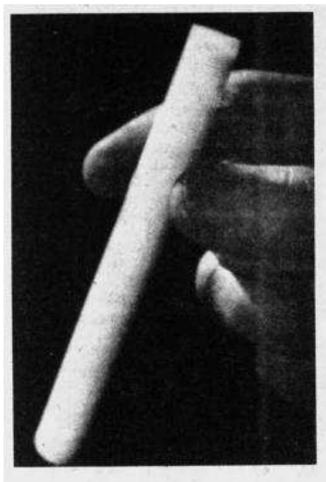
图 A \beta -氧化铝陶制电解质管 (摘自电化学协会研究中心, 公共运输用钠-硫电池)
