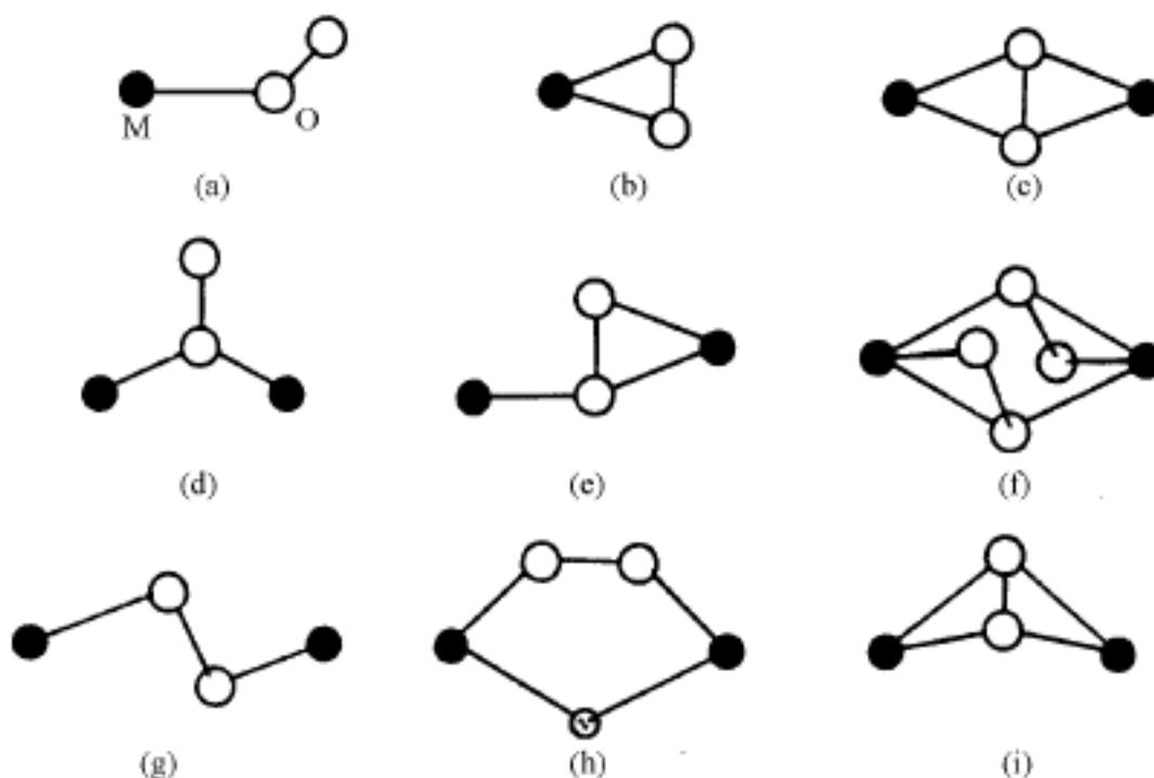
图 15.2.1 二氧金属配合物中 O<sub>2</sub> 配位型式
