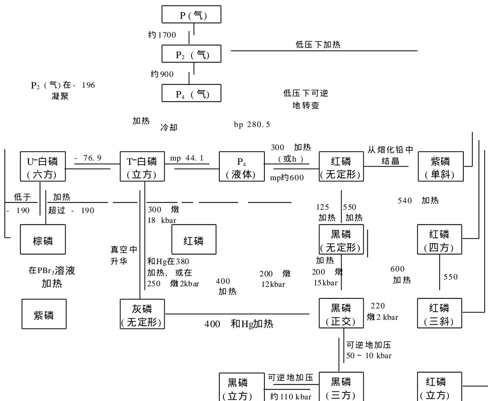
图 14.3.4 单质磷的各种形态间的互相转变的条件
