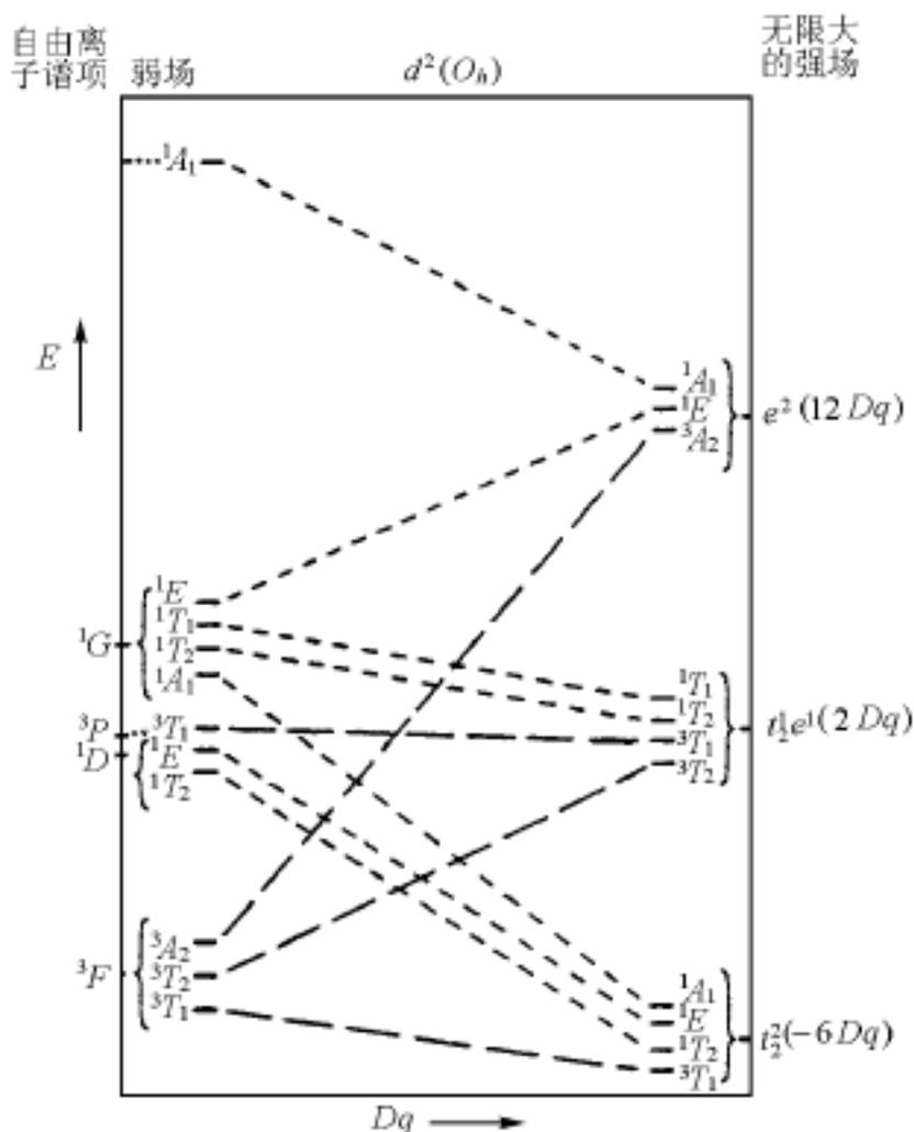
图 8.2.10  $d^2$  八面体配合物的相关图
