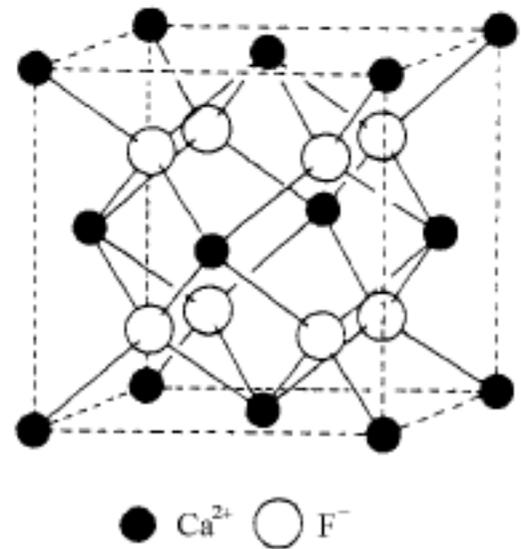
图 10.1.6  $\text{CaF}_2$  (萤石) 的结构
