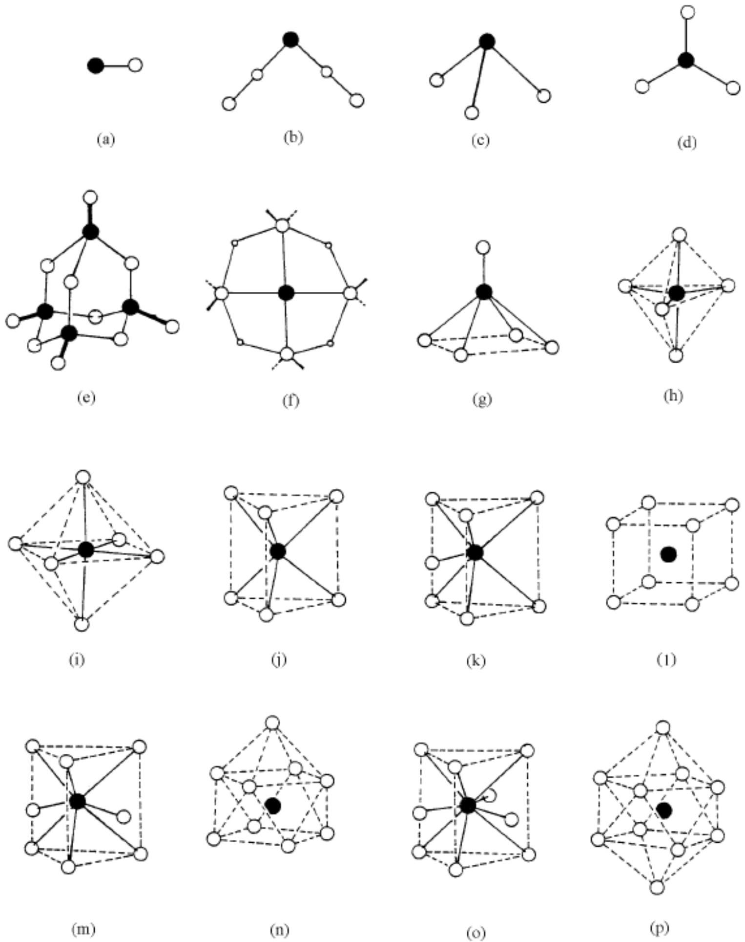
图 14.4.1 磷原子在化合物中的配位几何形状
