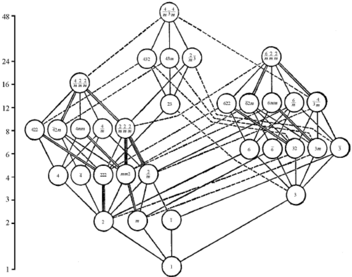
图 9.3.3 32 个晶体学点群的子母群关系
