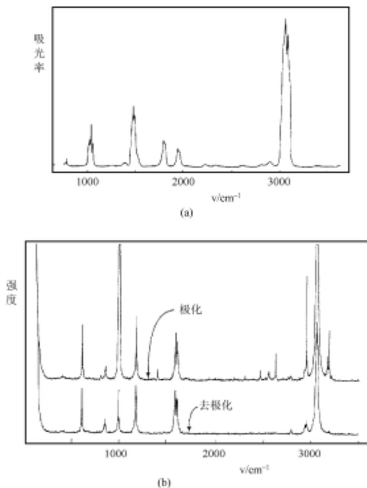
图 7.3.16 苯的 (a) IR 和 (b) Raman 光谱
