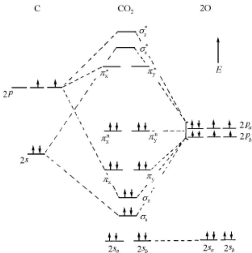
图 3.4.6 CO<sub>2</sub> 分子轨道能级图
