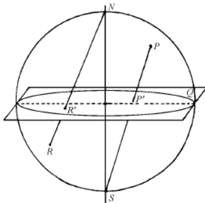
图 9.3.1 极射赤平投影原理
