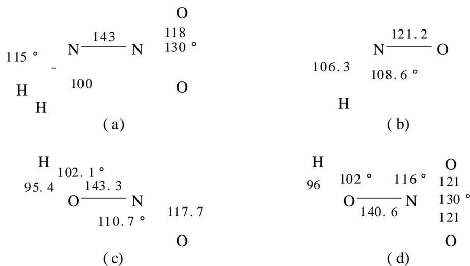
图 14.2.2 氮的含氧酸的结构(键长单位为 pm)
