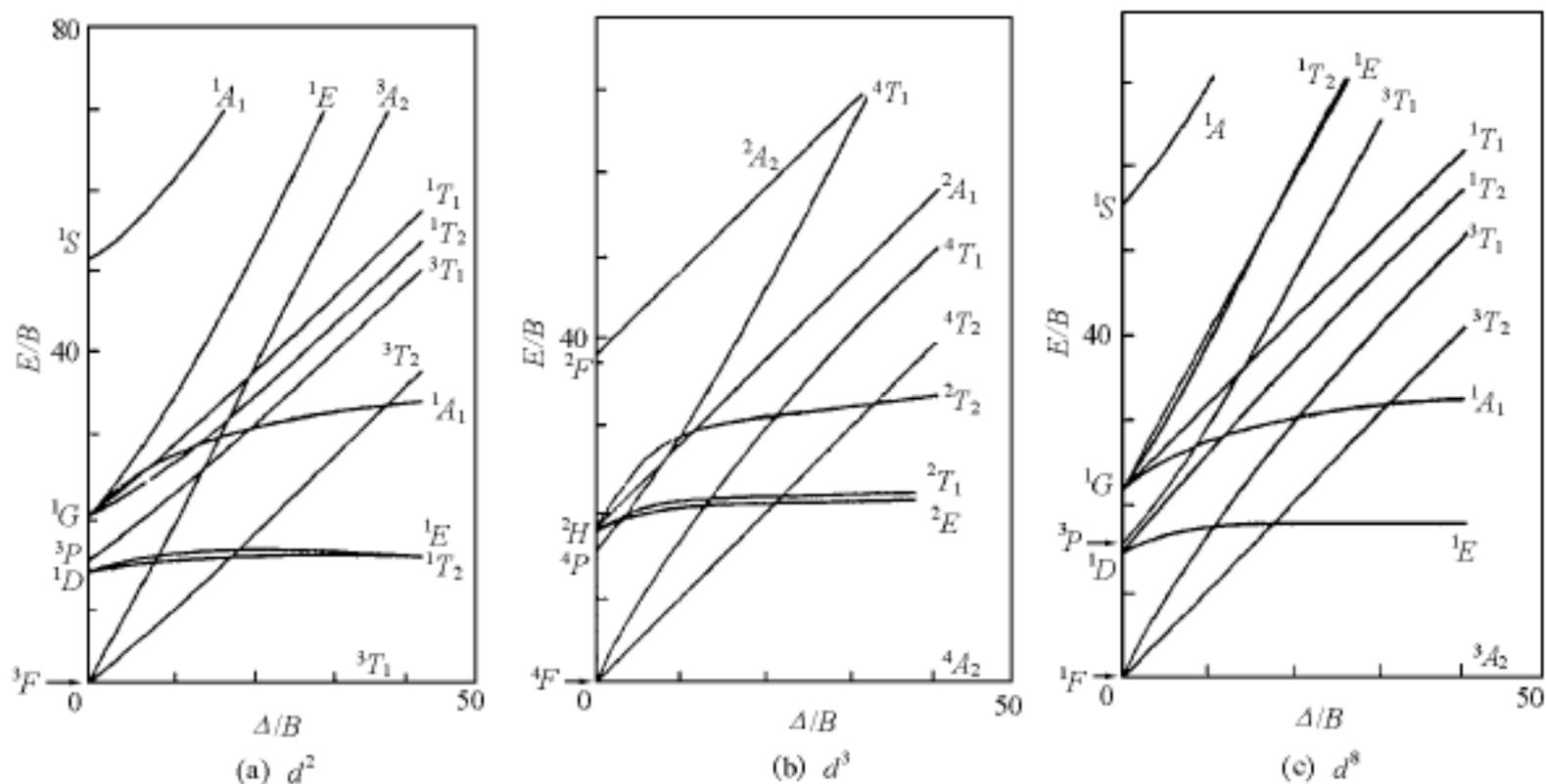
图 8.2.8  $d^2$ ,  $d^3$  和  $d^8$  八面体配合物的 Tanabe-Sugano 图
