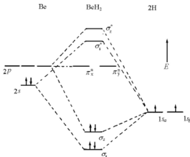
图 3.4.2  $\text{BeH}_2$  分子轨道的能级
