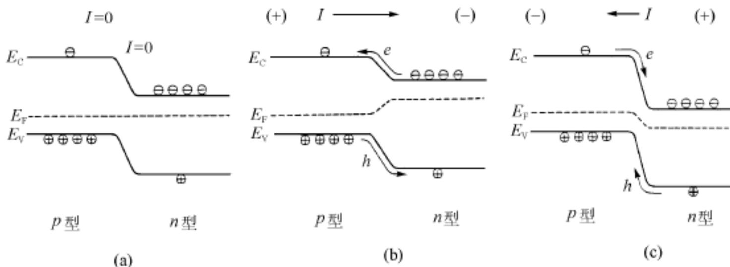
图 4.3.5 p-n 结中能级状态示意图
