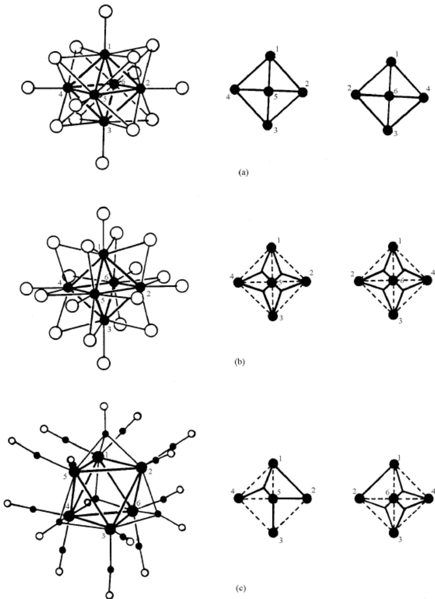
图 16.1.2 三种八面体簇合物的结构和键
