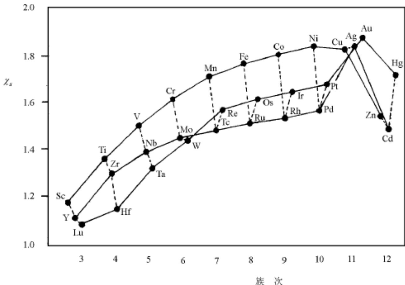
图 2.4.3 过渡金属元素的电负性  $\chi_s$  值和族次间的关系
