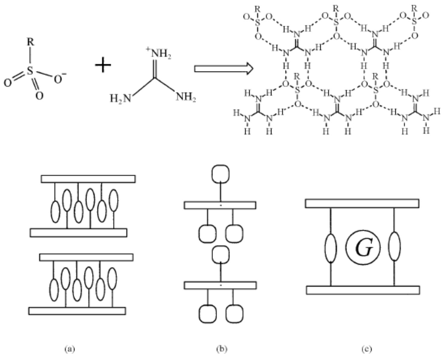
图 5.4.7 胍正离子和磺酸基团通过  $N \rightarrow H \rightarrow O$  氢键的自组装给出  $\infty^1$ -和  $\infty^2$ -网络
