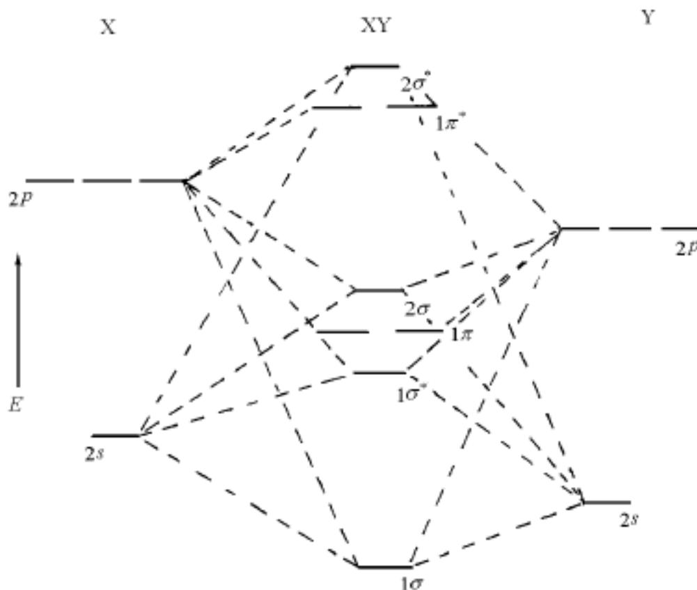
图 3.3.5 异核双原子分子 XY 的能级图
