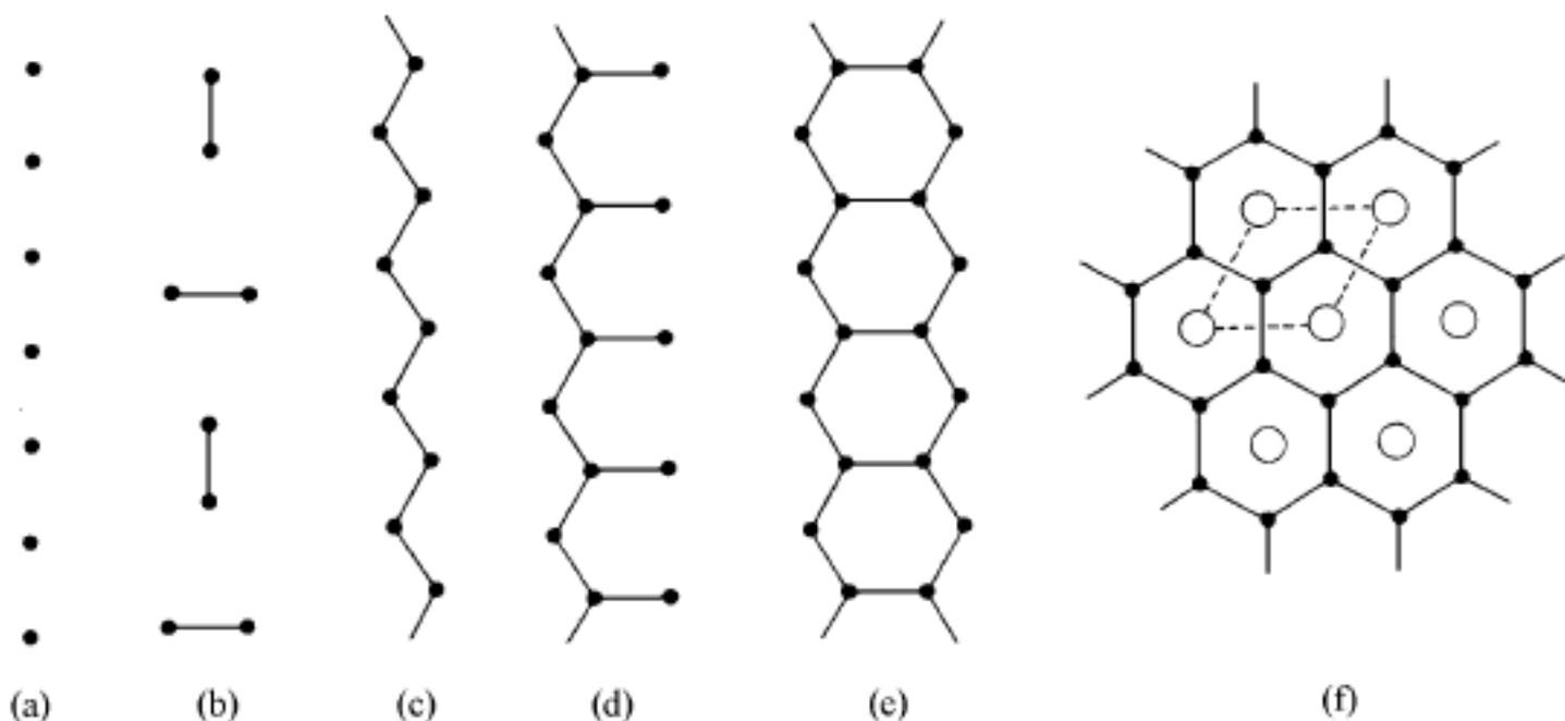
图 12.2.1 若干含硼较少的一些金属硼化物中硼原子的连接情况
