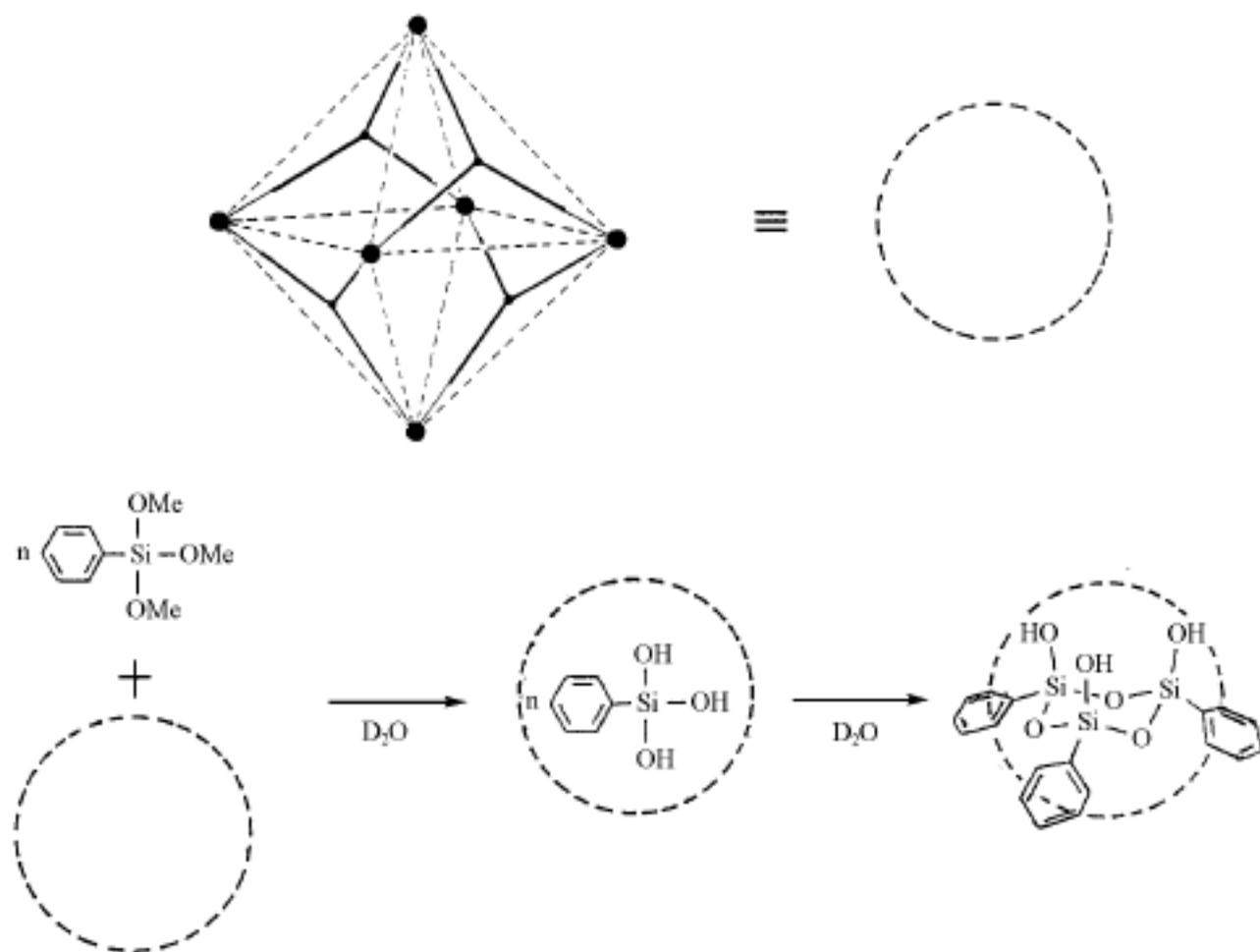
图 5.5.18 环硅氧烷三聚体在自组装的配位笼中形成并稳定化
