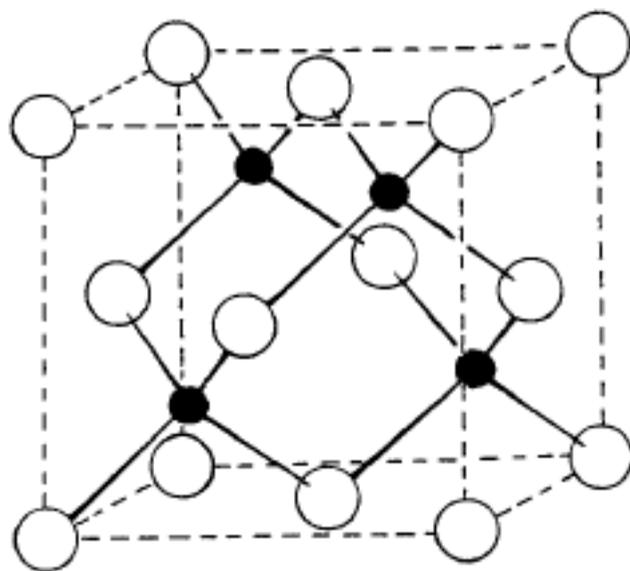
图 10.1.7 立方硫化锌的结构
