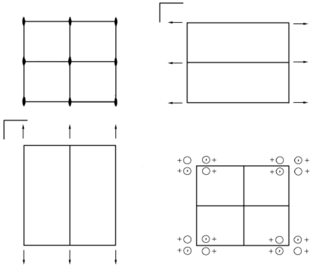
图 9.5.3  $C_{2v}^1$ -Pmm2 空间群对称元素和等效点系的排布
