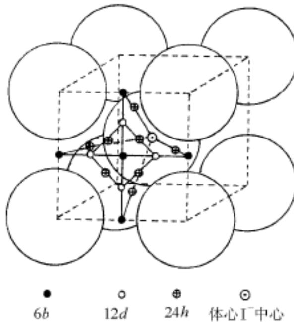
图 10.3.2  $\gamma$ -AgI 的结构
