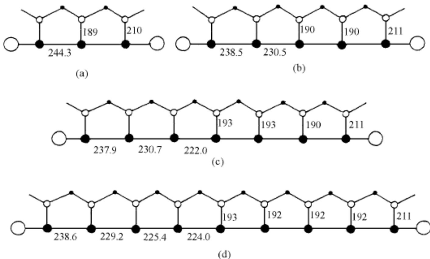
图 16.6.6 金属镍线性分子中 Ni→Ni 和 Ni→N 的键长, 单位为 pm
