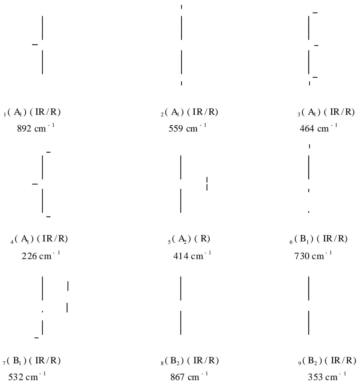
图 7.3.6  $SF_4$  的正则振动模式及其频率
