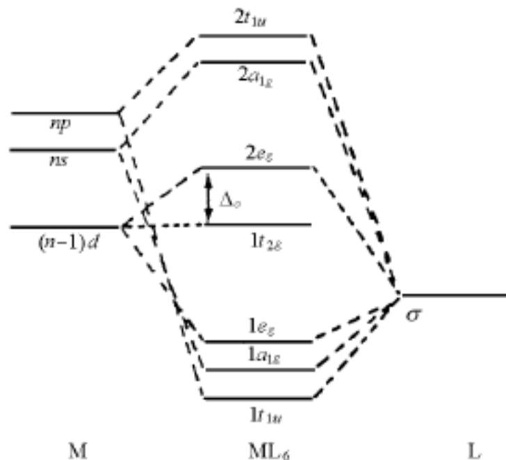
图 8.3.3 八面体配合物  $ML_6$  的能级图
