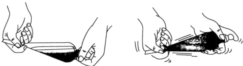
图 3-33 分液漏斗萃取示意图
